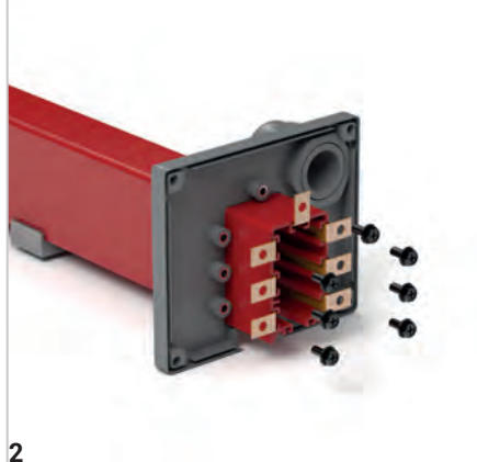
2 İletkenler besleme modülüne vidalanır. Rakordan girilerek besleme kabloları bağlanır.
